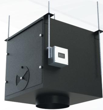
油扇クラッシャーとは肉を焼く時に出る油煙等を油扇クラッシャーによって0.3ミクロンまで砕く装置です。粒子は空気中に含まれる粉塵と同等です。ダクトの中を通る排煙は粉塵化となり外に排出されます。
