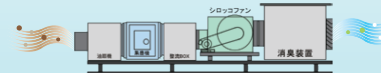
排煙消臭システム
